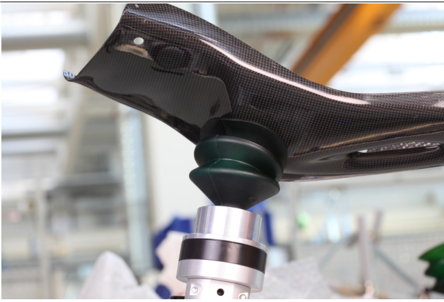
Uni-Base UB и рекомендуемая присоска RSC для зажима пластиковых деталей, армированных углеродным волокном
